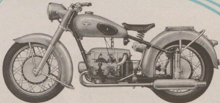
2 Zyl. Viertakt-Boxermotor, 597 ccm, 28 PS, 2 Vergaser, 90 Watt Lichtanlage, 4-Gang-Duplex-Kettengetriebe, Fußschaltung, Kardanantrieb, Teleskop-Allradfederung. Kraftstoffnormverbrauch 5,3 Ltr./100 km, Höchstgeschwindigkeit 140 km/std. solo.
