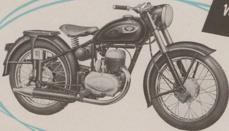
1 Zyl. Zweitakt-Einport-Blockmotor, 198 ccm, 8,3 PS, Einhebel-Doppelvergaser, Viergang-Ziehkeilgetriebe, Fußschaltung, geschlossener Kettenkasten, Teleskop-Allradfederung, Vollnabenbremsen, Kraftstoffnormverbrauch 2,45 Ltr./100 km, Höchstgeschwindigkeit 95 km/std. (liegend).
