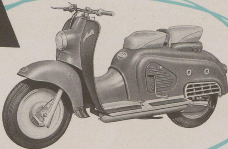
1 Zyl. Zweitakt-Blockmotor, 150 ccm, 7 PS, Viergang-Ziehkeilgetriebe mit Fußschaltung, Ferntupfer, getrennte Luftregulierung, el. Leerlaufanzeige, geschlossener Kettenkasten, Teleskopgabel, Hinterradschwinge mit Öldämpfer, 12" Räder, Normverbrauch 2,2 Ltr./100 km, Höchstgeschwindigkeit 80 km/std.
